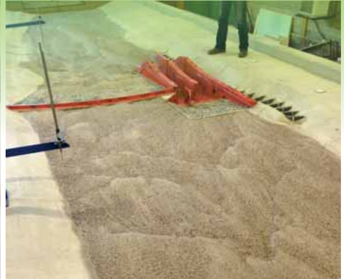
Nonner Rampe, Geschiebeversuch
